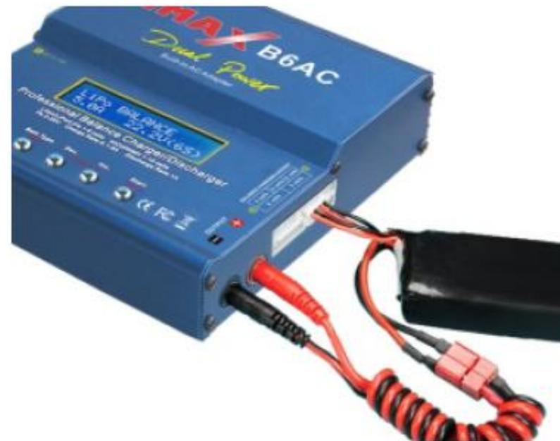
Силовые разъемы должны обязательно подключены быть наряду с балансировочными перед началом балансировки, как показано на рисунке.
