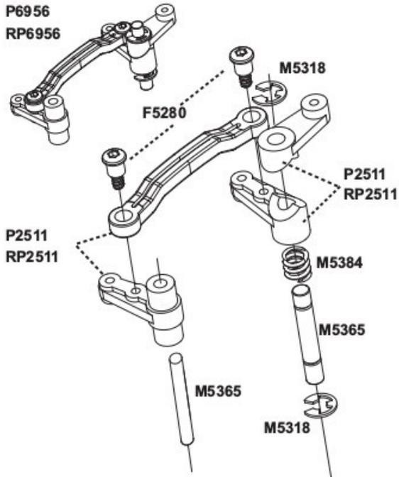
Steering Hubs Assembly 前轮座总成
