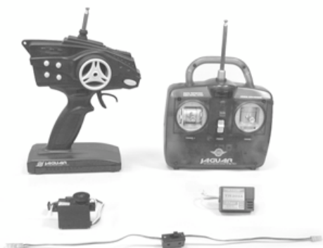
2-канальное радиоборудование со стандартным серво.
