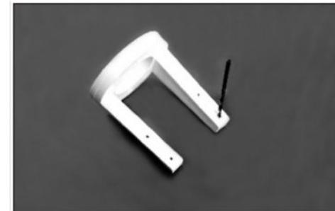
44. Выньте двигатель и раму из фюзеляжа. Просверлите 2,6 мм отверстие на отметках для 3x18 мм винтов.
