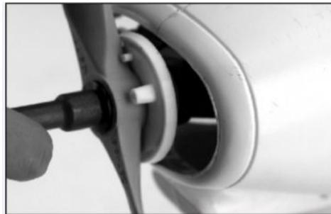
51. Наконiec, установите пропеллер и обтекатель. Пропеллер должен быть зажат креплениями панели обтекателя. Подстройте наклон пропеллера.
