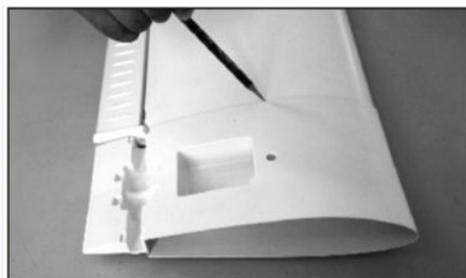
4. Вставьте крыло в муфту так, чтобы полуотверстие на внутренней части крыла было как раз под отверстием в муфте. Возьмите карандаш и отметьте на крыле черту в месте, где заканчивается муфта. Выньте крыло и зачистите наждаком места склейки. Затем нанесите слой эпоксидного клея на внутреннюю и внешнюю поверхность в местах склейки.
