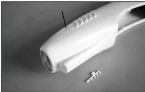
9. Просверлите четыре 3мм отверстия под крепления теплового кожуха. Приклейте их на место циакрилом.
