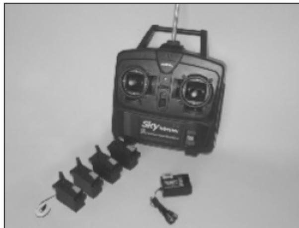
Радиосистема: Передатчик, приёмник, 4 серво, удлинители проводки серво, регулятор скорости (для электромоторов), авиабатарея. Все компоненты подбираются самостоятельно. Рекомендуем вам обратиться к опытному моделисту за помощью.
