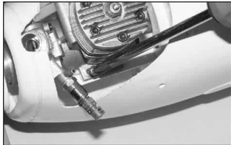
48. Закрепите двигатель четырьмя винтами 3x18мм.
