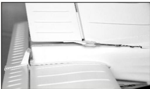
55. Другой конец тяги присоедините к рулю направления. Предварительно проденьте тягу в трубку. Конец получившегося боудена проденьте в отверстие на штифте с резьбой на другом конце. Зафиксируйте тягу так же как в предыдущем пункте. Штифт вкручивается в V-образный зажим, который и подсоединяется к держателю корда руля направления.
