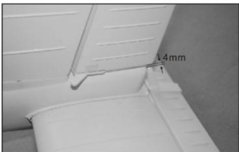
33. Установите и подстройте вертикальный стабилизатор так, чтобы между рулём высоты и фюзеляжем получился зазор в 4 мм.
