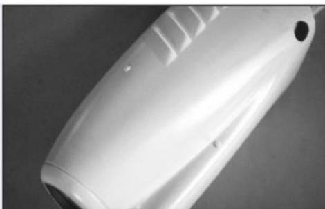
10. Прорежьте два 5,5 мм отверстия, для стоек шасси.
