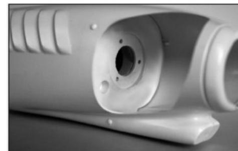
14. Установите тепловой кожух (в сборке с перегородкой) в фюзеляж как на фото. Нажмите на него, чтобы он зашёл в крепления, подготовленные ранее. Приклейте его по периметру циакрилом, или эпоксидным клеем.
