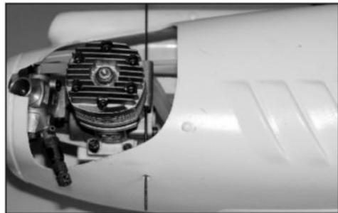
49. Используйте отверстие глушителя как ориентир для того, чтобы просверлить отверстия в фюзеляже. Расширьте
