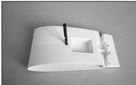
1. Прodelайте отверстие в 7,5мм на отметке центральной муфты крыла, для болта крепления
