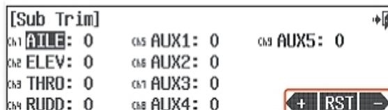
**Внимание:** Меню субтриммеров – не то место, где делаются серьёзные регулировки. Любое серво, требующее регулировки, превышающей 40 шагов движения, должно быть отстроено с помощью перемещения качалки или регулировки тяги.
