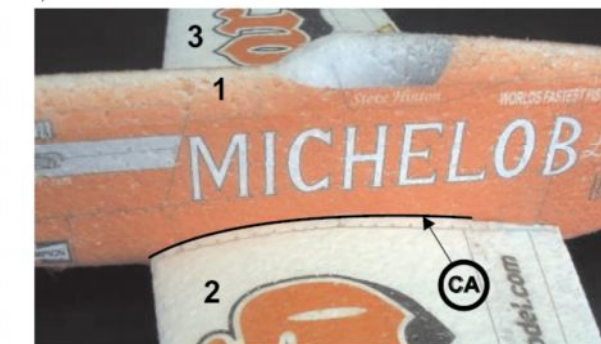
Выверните крылья. Проверьте, чтобы они стояли симметрично. Вклейте крылья в фюзеляж.
