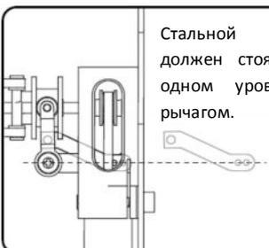
Стальной шар должен стоять на одном уровне с рычагом.
