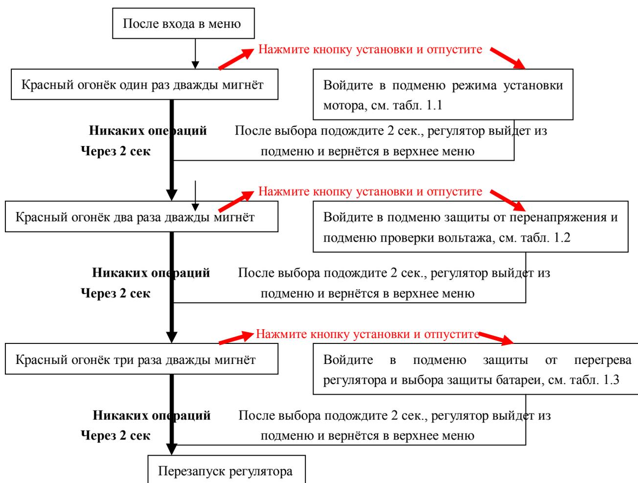
**Как выбрать правильные настройки для себя:** Когда вы входите в каждое подменю, вы можете считывать определённые параметры с помощью разнообразных комбинаций мигания огоньков, для получения более подробных инструкций, пожалуйста, просмотрите каждую таблицу данных. В течение 2 сек. Вы можете изменять параметры, нажимая кнопку установки, руководствуясь комбинациями огоньков в
