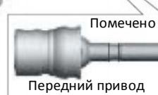
Протолкните кардан, чтобы убрать зазор, затем затяните винт-фиксатор на ведущей шестерне.
